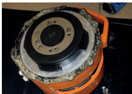
Cubierta del amortiguador removida
